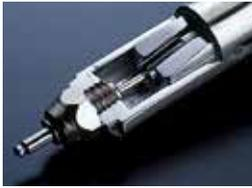
KingSetでは3分割ジョーを採用。これによりリベットを破断する際の応力を分散できジョーの寿命が格段に向上しました。
