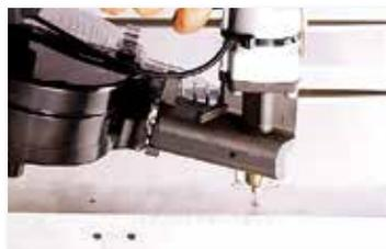
トリガーを引くとリベットが自動装填され、再度トリガーを引くとリベットを破断すると同時に次のリベットを自動装填します。
