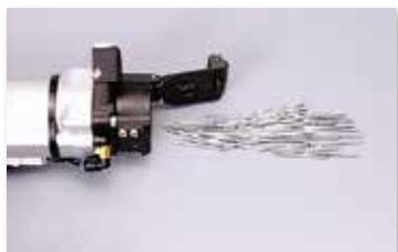
リベット作業（1コイル）終了後、内部に収納されたマンドレルを廃棄します。
