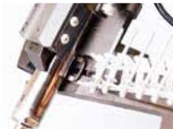
テープ連結されたリベットのセットは約10秒で終了します。トリガーを引くとリベット装着、締結を自動で繰り返す連続作業が行えます。
