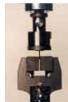
破断試験
