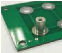
Reel Mounted SPACERは表面実装基板への取付コスト低減を実現します。Reel Mounted SPACERは、チップマウンター(Pick and Place)装置を使って、テーブリールから供給される仕組みで、リフローにて半田づけされます。
